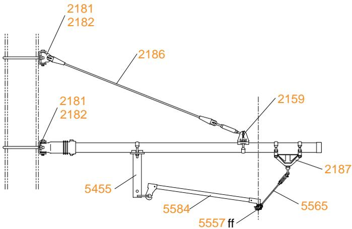
Consoles tubulaires au-dessus deux voies, avec attache pour bras de retenue
